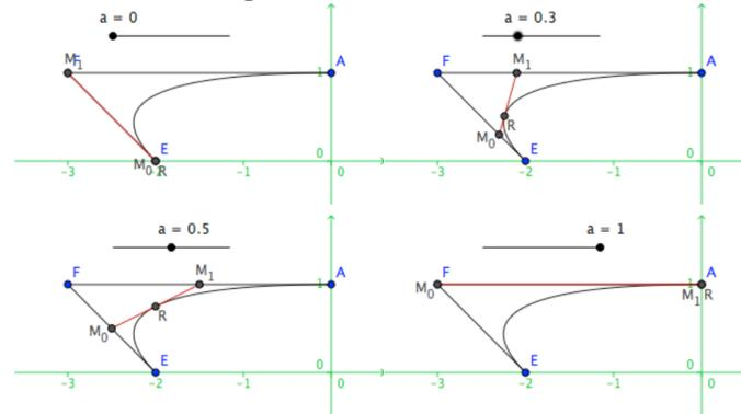
C'est ce qu'on appelle la construction de la courbe de Bézier par barycentres. La courbe de Bézier de A,B,C est l'ensemble des barycentres  $R = \{K_a L_{1-a}\}$  avec  $K = \{A_a B_{1-a}\}$  et  $L = \{B_a C_{1-a}\}$ .
